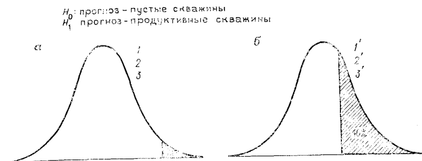
Рис. 2.27. Распределение статистического критерия с критической областью, определяющей отклонение гипотезы о том, что разведка безрезультатна:
